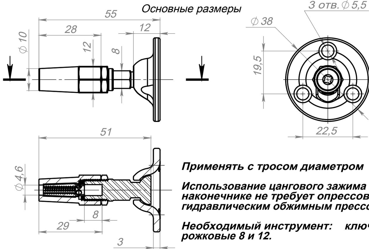
Применять с тросом диаметром 3 мм.
